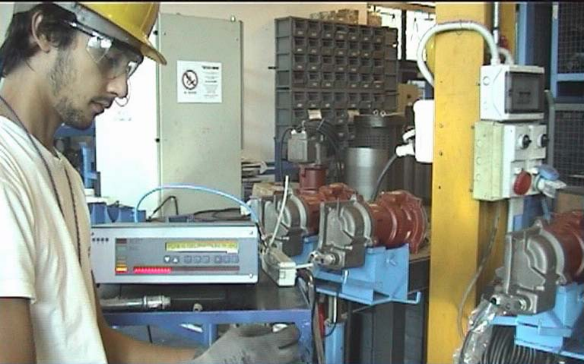
Macchina a depressione per controllare perdite d'aria Electronically control device used for depressurizing
